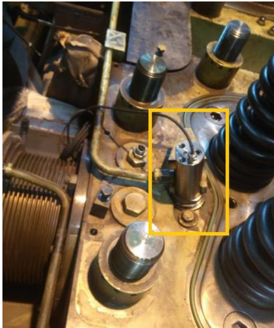
Figura 28 - Bico injetor de combustível piloto.
