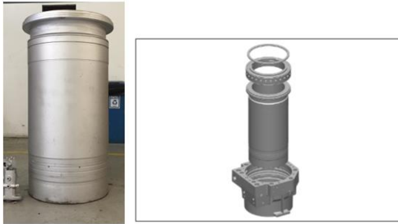
Figura 22 - Camisa de cilindro de um motor com 48 cm de diâmetro e 60 cm de curso.
