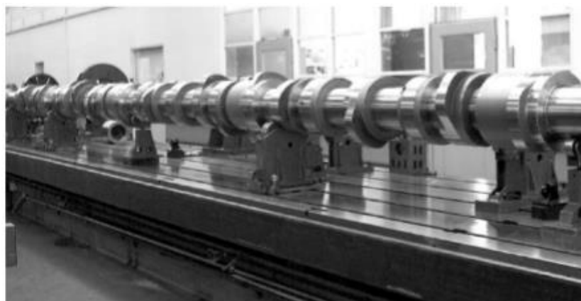
Figura 25 - Eixo ou árvore do comando de válvulas (Turbo, 2004)
