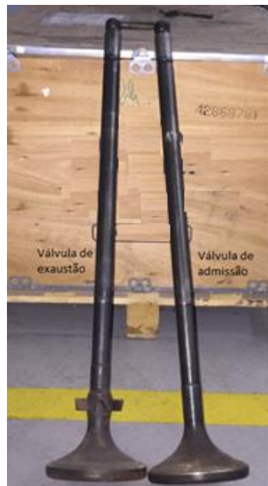
Figura 24 - Diferenças de formas das válvulas de admissão e exaustão.
